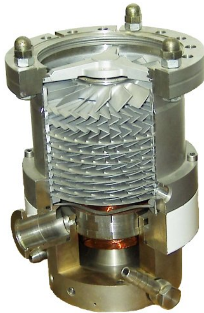
Abbildung 8: Foto einer aufgeschnittenen Turbomolekularpumpe
